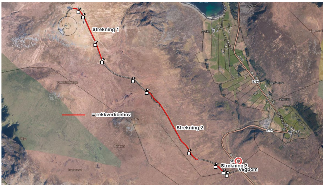
Skisse frå kommunalteknikk med oversikt over rekkverksbehov.
