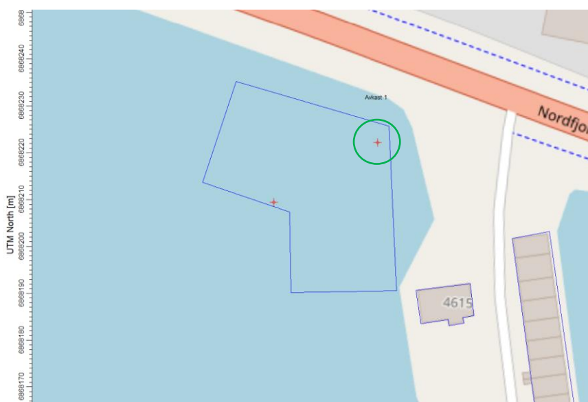
Figur 3-2: Bygget markert i modellen. Røde punkter er avkastplasseringer som er testet i modellen. Resultatene presentert i rapporten er for avkastet nordøst på bygget, markert med grønn ring.
